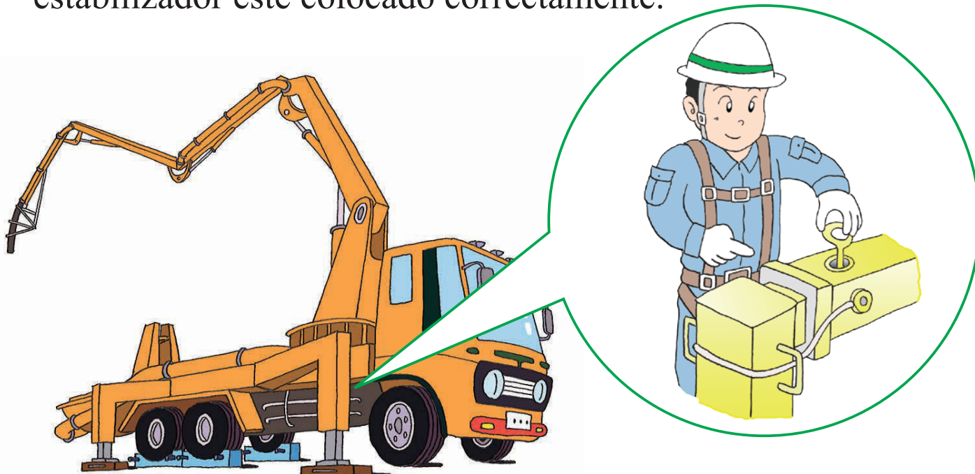
Verificación del dispositivo de prevención de desenchajado del estabilizador.
