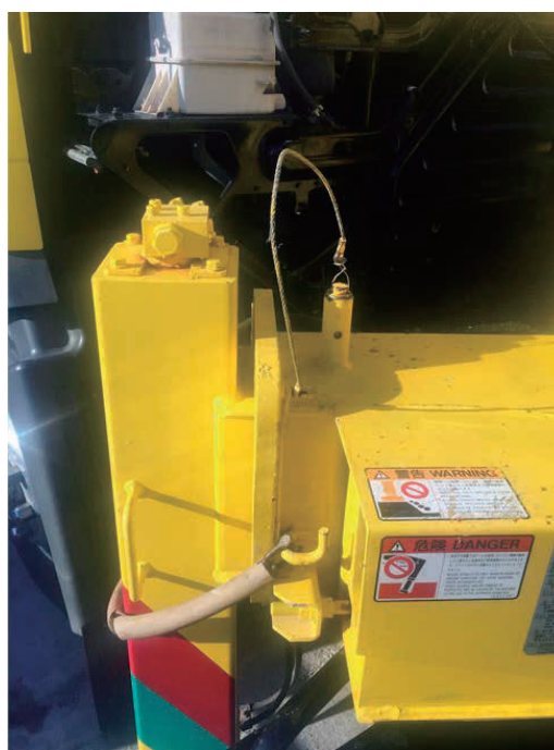
Ejemplo de pasador de bloqueo y cadena de prevención de desenchajado.
