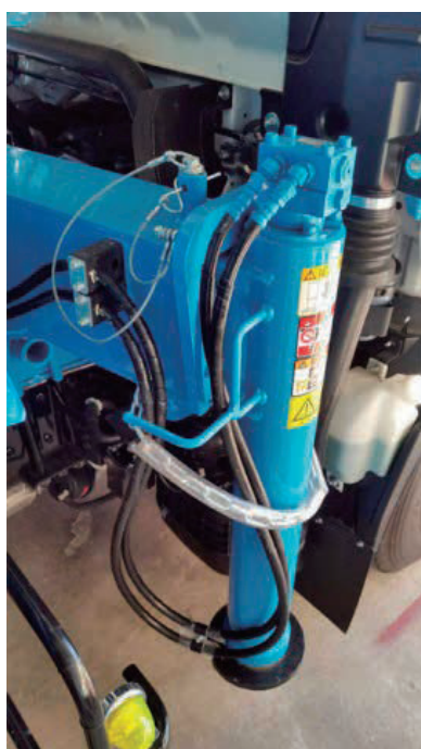
Ejemplo de pasador de bloqueo y cadena de prevención de desenchajado.
