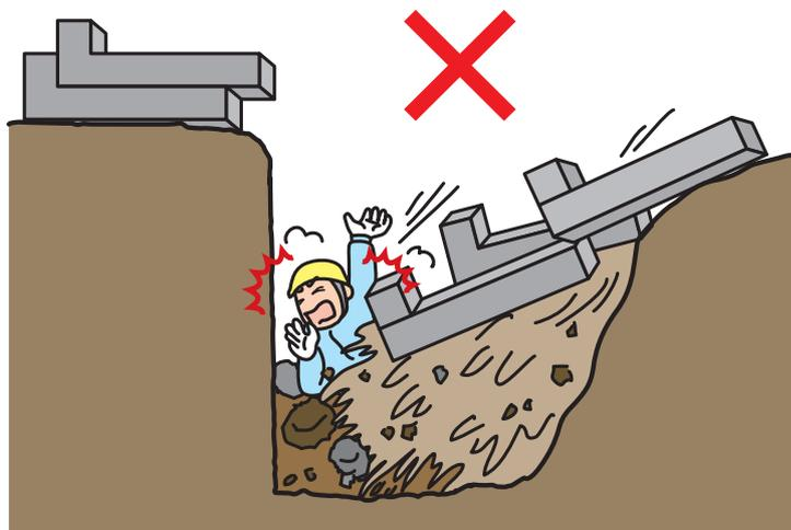
[2] Instalamos barricadas en la cabecera del talud y en las banquetas para prevenir vuelcos.
