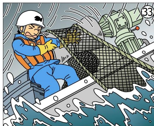
**Exemplo de acidente 2:** No meio de um temporal, um tripulante estava usando um transportador para içar a rede. Quando o navio balançou violentamente, ele perdeu o equilíbrio e a manga da sua capa de chuva ficou presa no transportador de rede, enroscando a sua mão e braço esquerdos. ③③
